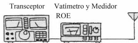
Comenzar el ajuste en la frecuencia más alta acortando los elementos de ajuste por igual buscando la mejor medida de ROE en la frecuencia de resonancia deseada. Un acortamiento excesivo hará perder la frecuencia de resonancia, así que acortar poco a poco.
